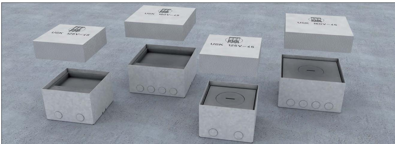
Четырёхугольные простые лючки серии BS, с внешними размерами 125x125 мм и 160x160 мм, предназначены для монтажа непосредственно на сыром полу и, в зависимости от крышки, подходят для сухой и влажной уборки. Комплект включает в себя напольную коробку, стальной лючок и опалубку. Для напольных покрытий 12/22 мм. Возможная высота: 80-125 мм или 90-135 мм.
