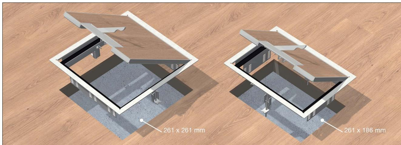
Четырёхугольные кассетные лючки из нержавеющей стали с напольной рамкой и внешними размерами 284x284 или 284x211 мм, предназначены для монтажа в пустотных полах или фальшполах. Для паркетного покрытия толщиной 12/22 мм.
