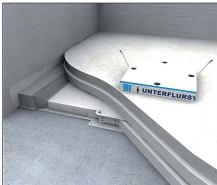
После монтажа канала и заклейки всех отверстий, уложите шумоизоляцию и залейте стяжкой.
