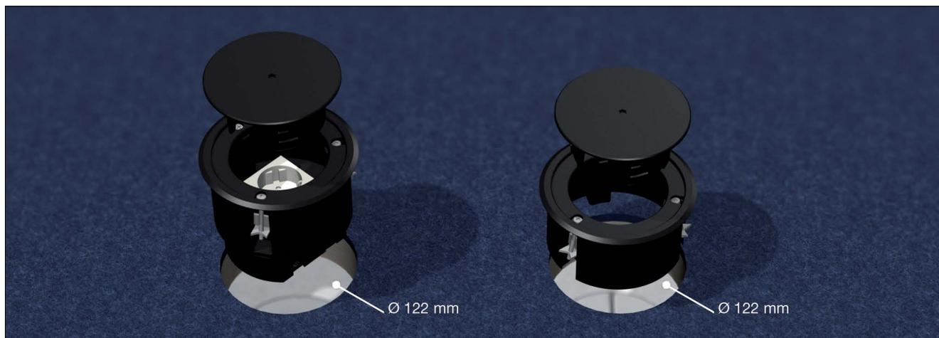
Круглые пластиковые лючки диаметром 133 мм (посадочное место 122 мм), предназначены для установки двух модулей: 45x45 и 22x45мм. Подходят для монтажа в двойных или пустотных полах.
