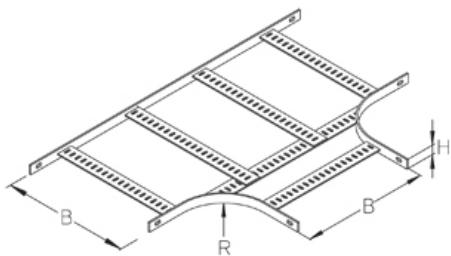
Отвод судового лестничного лотка в виде Т-образного элемента
