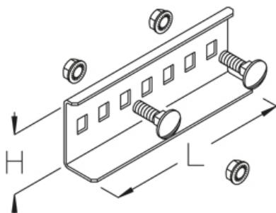
соединитель, высота=60 мм
