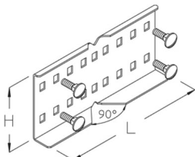
Соединитель, горизонтальный, высота=100 мм
