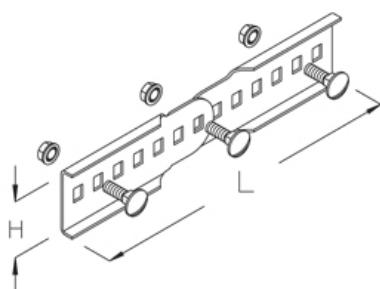
Соединитель, вертикальный, высота=60 мм
