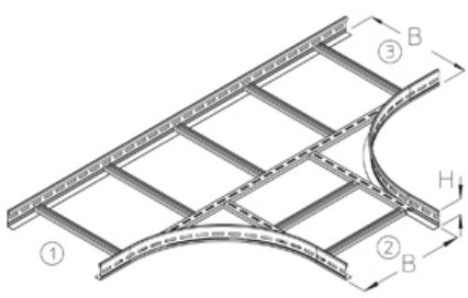
Т-образный отвод, высота=60 мм
