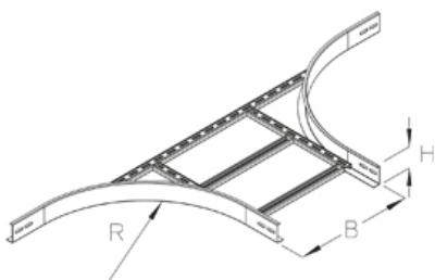
Накладной отвод, высота=100 мм
