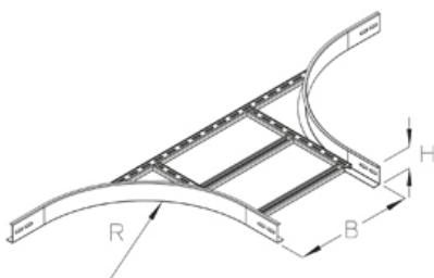
Накладной отвод, высота=60 мм
