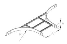
Накладной отвод, высота=60 мм
