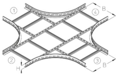
Х-образный отвод, высота=100 мм
