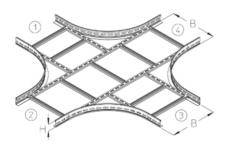
Х-образный отвод, высота=100 мм
