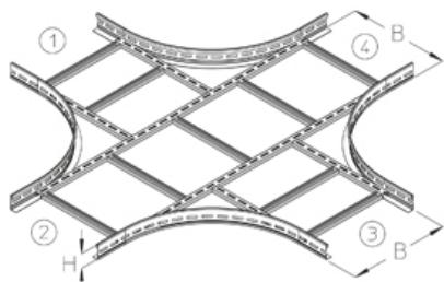
X-образный отвод, высота=60 мм
