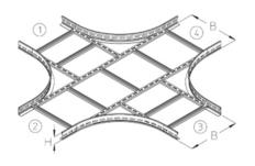
Х-образный отвод, высота=60 мм
