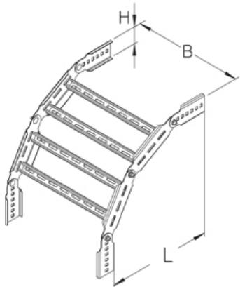
Угол вертикальный, высота=60 мм
