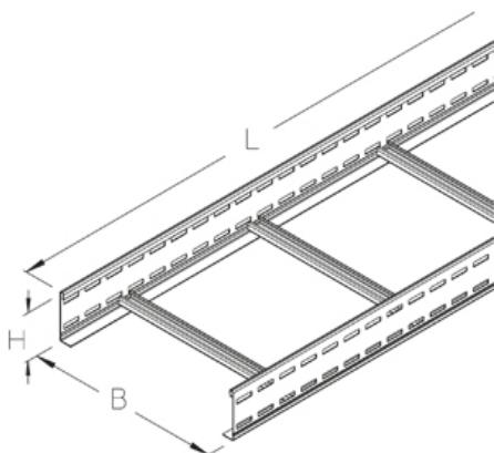
Лестничный лоток тяжелый, высота 100 мм, ширина 200-600 мм, длина 3000/6000 мм
