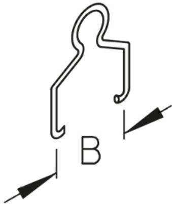
Подвесная скоба для крепления монтажных лотков с помощью цепи
