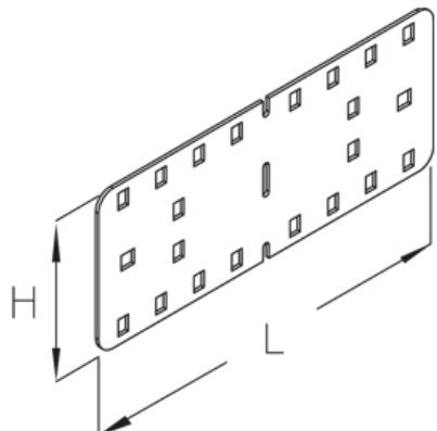
Соединитель, высота=95 мм
