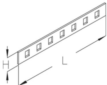
Соединитель, высота=20 мм
