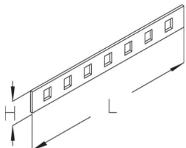
Соединитель, высота=20 мм
