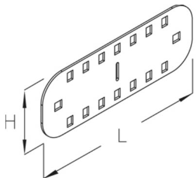
Соединитель, высота=70 мм
