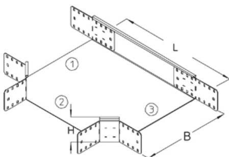
Т-образный ответвитель, высота=110 мм
