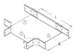
Т-образный ответвитель, высота=110 мм
