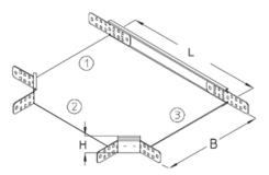
Т-образный ответвитель, высота=35 мм
