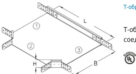
Т-образный ответвитель, высота=35 мм
