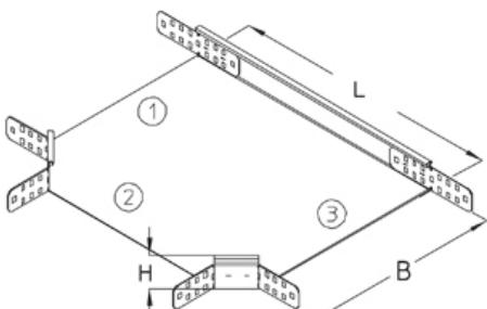
Т-образный ответвитель, высота=60 мм
