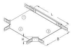
Т-образный ответвитель, высота=60 мм
