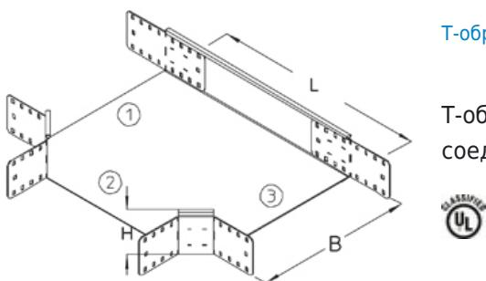
Т-образный ответвитель, высота=85 мм
