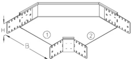
Угол листового лотка, горизонтальный 90°, со встроенными соединителями
