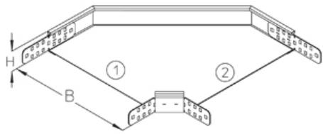
Угол листового лотка, горизонтальный 90°, со встроенными соединителями
