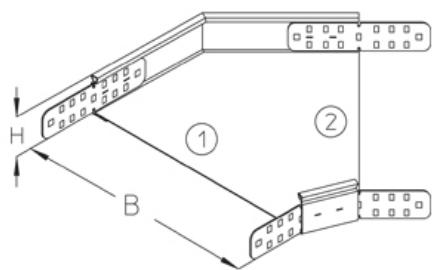
Угол горизонтальный 90°, высота=85 мм
