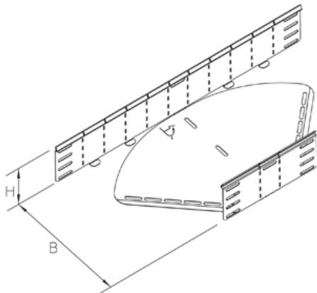
Угол горизонтальный, изменяемый, высота=110 мм
