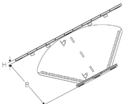
Угол горизонтальный, изменяемый, высота=35 мм
