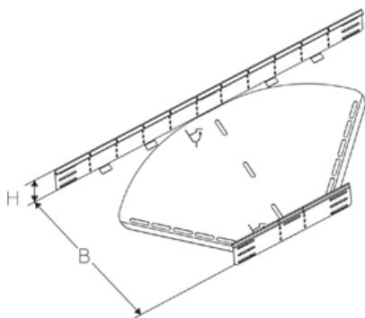
Угол горизонтальный, изменяемый, высота=85 мм
