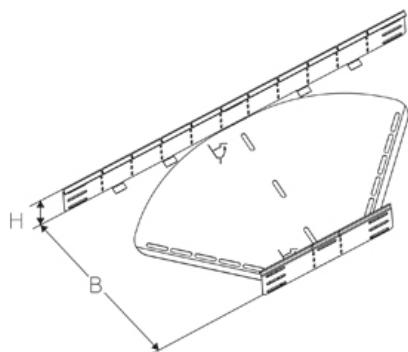
Угол горизонтальный, изменяемый, высота=85 мм
