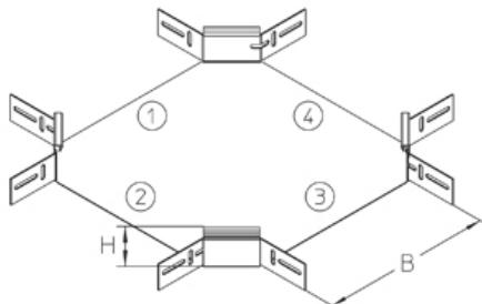
X-образный ответвитель, высота=60 мм
