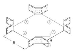
Х-образный ответвитель, высота=110 мм
