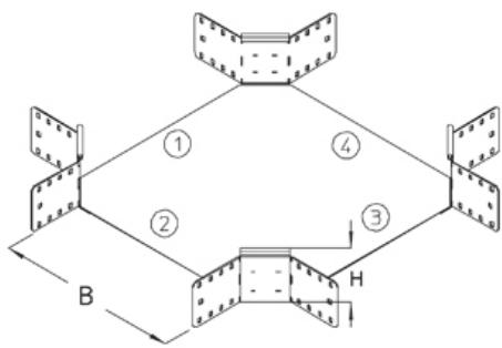
X-образный ответвитель, высота=110 мм
