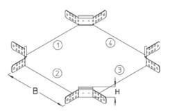
Х-образный ответвитель, высота=35 мм
