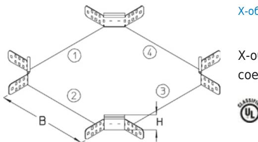
X-образный ответвитель, высота=35 мм
