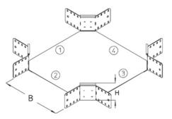
Х-образный ответвитель, высота=85 мм
