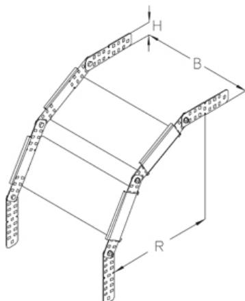
Угол вертикальный, высота=110 мм
