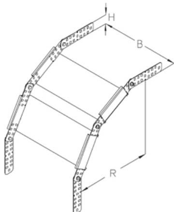
Угол вертикальный, высота=35мм
