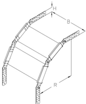
Угол вертикальный, высота=85 мм
