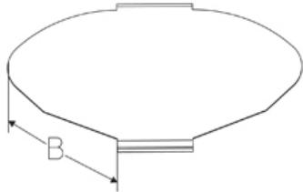
Крышка угла для листового лотка, самофиксирующаяся
