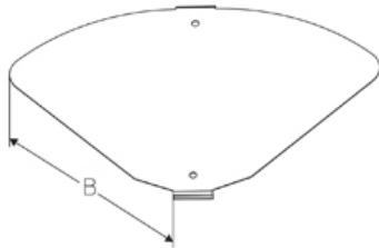
Крышка угла для листового лотка, самофиксирующаяся с запорами
