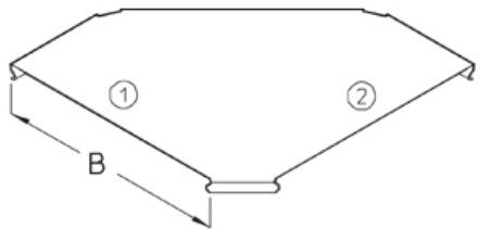
Крышка угла для листового лотка, самофиксирующаяся
