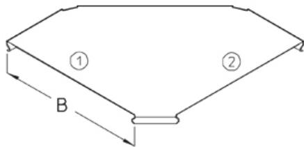
Крышка угла для листового лотка, самофиксирующаяся
