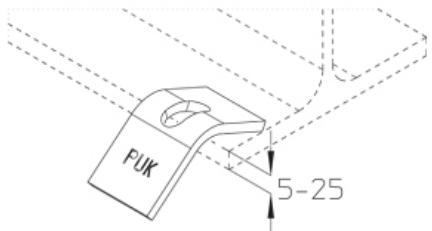
Горячекатаная методом погружения, по DIN EN ISO 1461
