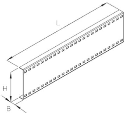
Соединитель, высота=200 мм
