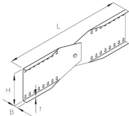
Соединитель вертикальный, высота=200 мм
