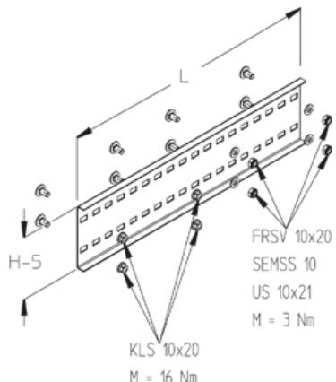
Соединитель, высота=115 мм
