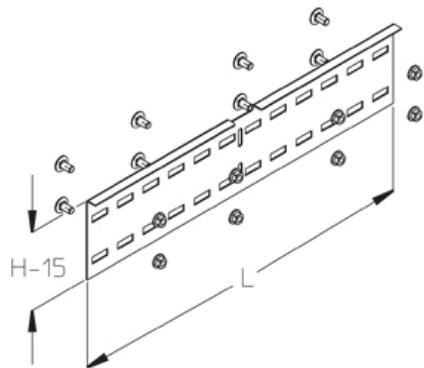
Соединитель, горизонтальный, высота=135 мм
