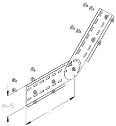
Соединитель, вертикальный, высота=95 мм
