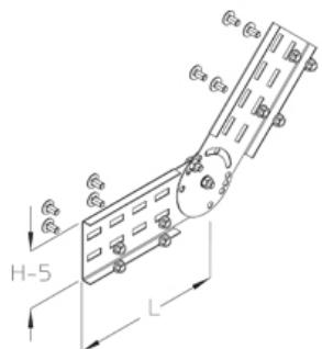
Соединитель, вертикальный, высота=115 мм
