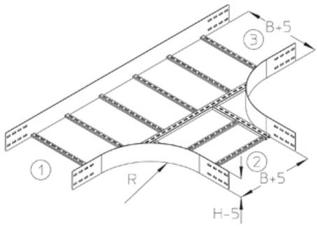
Т-образный отвод, высота=120 мм
