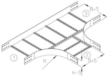
Т-образный отвод, высота=150 мм
