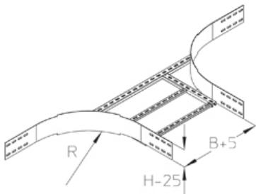
Накладной отвод, высота=120 мм
