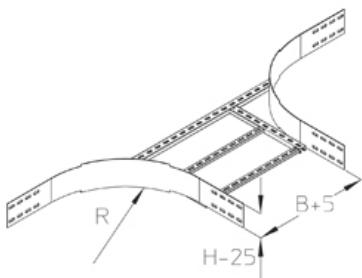
Накладной отвод, высота=100 мм
