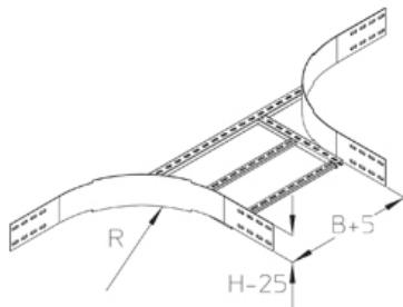
Накладной отвод, высота=100 мм
