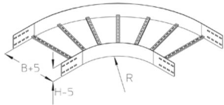
Угол лестничного лотка для больших пролетов горизонтальный 90 со встроенными соединителями
