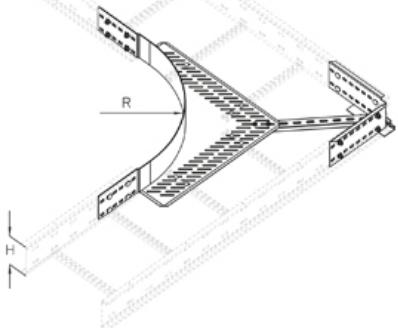
**Горячекатаная методом погружения, по DIN EN ISO 1461**
