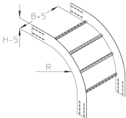
Угол вертикальный внешний, высота=120 мм
